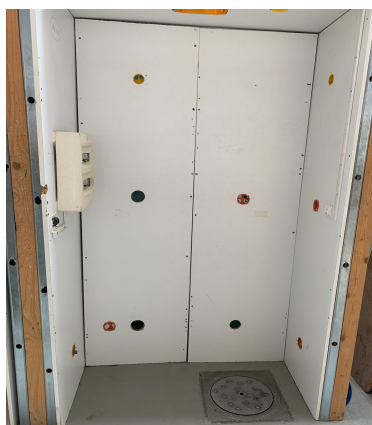
Figure 1 : un box dédié aux apprentissages des montages de circuits électriques domestiques en classe de 2e MELEC du public (dimensions 1,20m x 0,80m x 2,20m).
